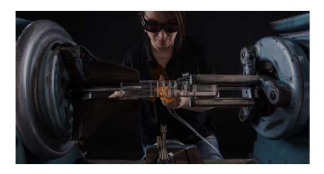
工匠 Dalibor Farny 凭精湛技术将每个玻璃管变成辉光管, 当中的阳极装配于金属网格上, 另有十条 0.1 毫米粗的钢质阴极数字, 可以显示 0 至 9 (数字与 URWERK 腕表表盘数字的字款相同)。每个辉光管由 88 个零件组成,由工匠以精细镊子逐一组装,可堪媲美精密机械结构,可作多种模式显示,极之流丽悦目,显得充满美感又轻盈。
