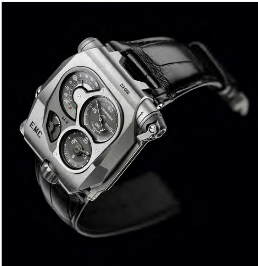
EMC 有四個獨立顯示部份：左上角為每天負 20 秒至正 20 秒的即時顯示精確度顯示器，右上角為連平衡砝碼的秒針，右下角為小時分鐘盤，左下角為 80 小時動力儲備顯示；翻過錶背可見 URWERK 自製機芯連集成電路板 (即 EMC 的大腦)，近錶冠位置是兩個發條鼓其中一個，近曲柄把手那一邊是擺輪的頂部以及電子監測器。
