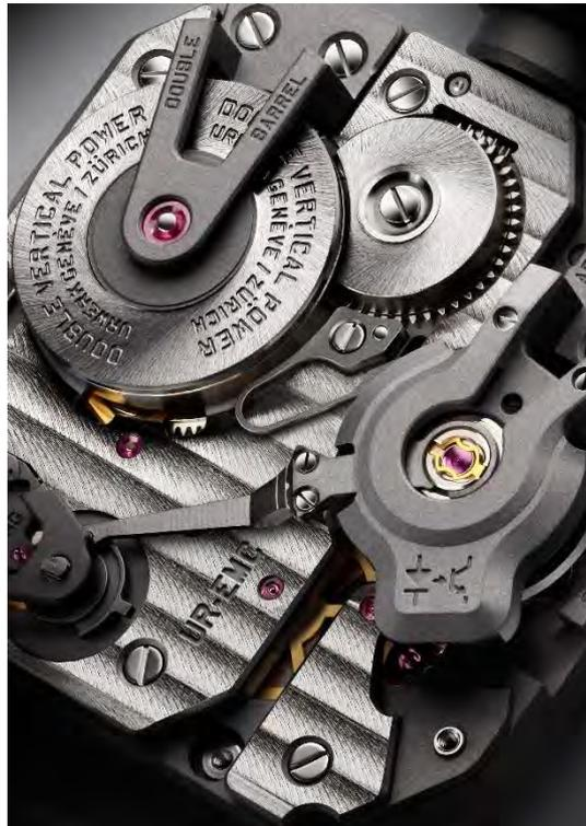
表背除了透视机芯精美造工修饰之外，亦可见到微调螺丝，以及表盘底部表耳之间松开表冠的按钮，还有双发条鼓盖面装置测量摆幅的光学传感器，传感器由一条小电线连着右边栅格下的的电路板，电路板旁边是两个迭起的发条鼓。
