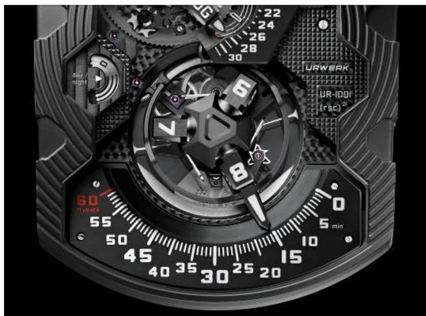
**Ретроградная минутная стрелка.** Ретроградная минутная стрелка закреплена на хорошо видимом пружинном кольце по окружности сателлитного усложнения. Это кольцо приводится в движение сателлитом часов: лирообразная пружина зацепляет зубчики двух коаксиальных кулачков, которые скользят по направляющей рейке минутной стрелки. Когда стрелка достигает конца своего хода, то есть отметки 60 минут, зубчатые кулачки направляют ее ретроградный ход к нулю, где ее ждет сателлит следующего часа.
