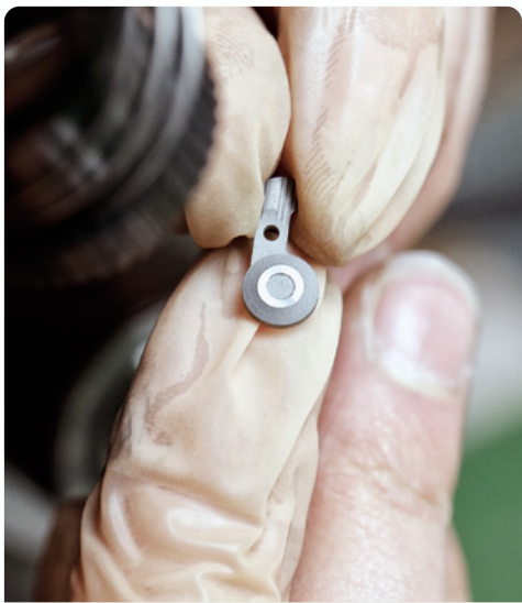
UR-105 TA腕表的卷绕模式由一条喷砂及拉丝小杠杆决定
