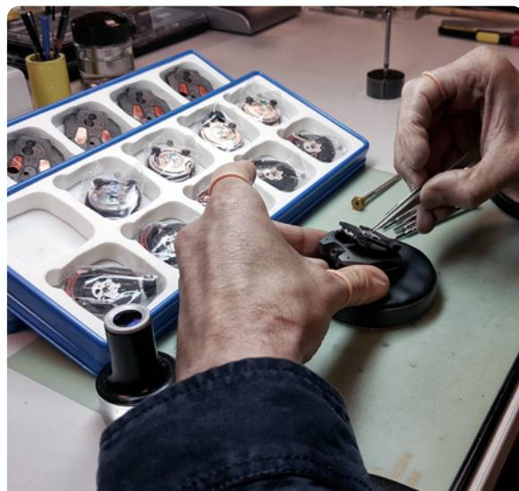
装配机芯。一整周测试前的最后及最关键步骤之一。
