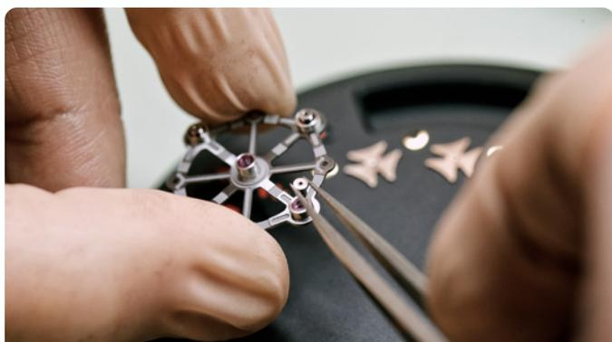
Невидимая карусель, покрытая рутением, прошла пескоструйную обработку. Окончательная обработка детали соответствует высочайшим стандартам haute horlogerie.
