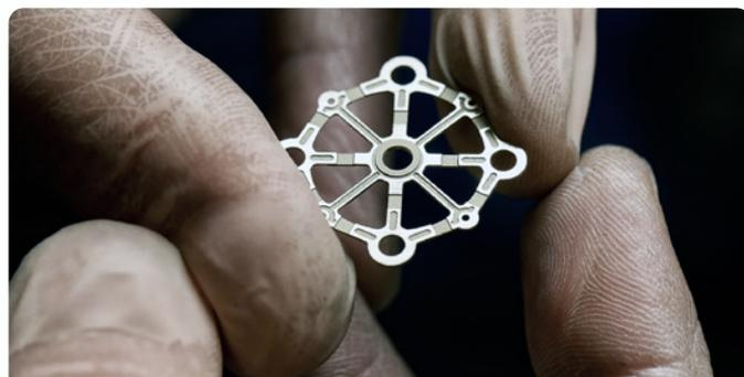
Невидимая карусель отвечает за работу спутникового указателя часа. Это главная деталь оригинального механизма.
