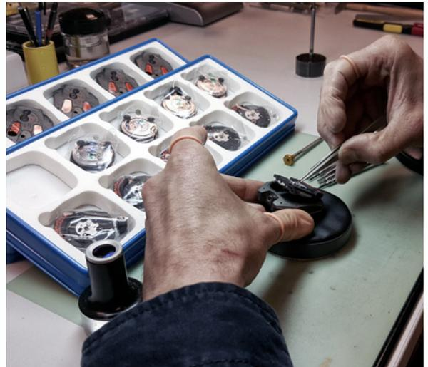
Механизм часов устанавливается в корпус. Это один из окончательных и особенно важных этапов, предваряющих целую неделю тестирования.
