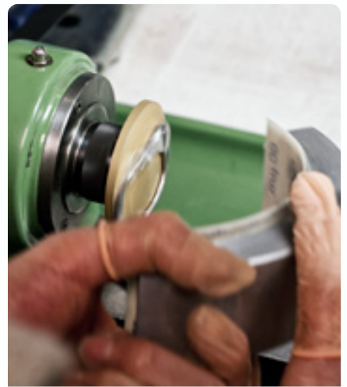
El bisel del UR-105 TA es de acero con un acabado cepillado.
