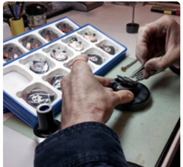
Introducir el movimiento en la caja es el paso final y uno de los más delicados antes de una semana entera de pruebas.
