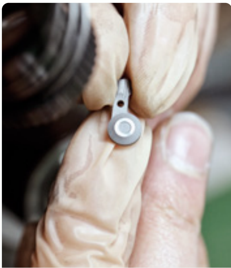
El modo de carga en el UR-105 TA se selecciona mediante una pequeña palanca de titanio pulido con chorro de arena y cepillado.
